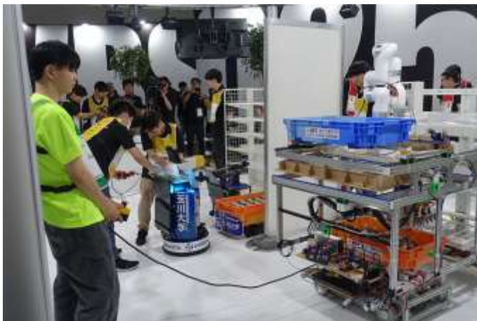
図 4.2.1 - 3 おにぎりをケースから取り出して陳列棚に設置する作業を自動化。正確性やスピードを競う。
