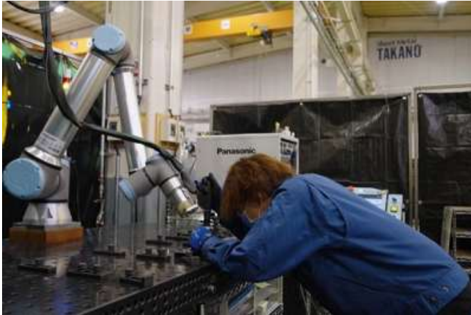
図 2.4.2-1 ユニバーサルロボットの 協働ロボットを導入したタカノ は溶接作業を自動化した 出典：日刊工業新聞社
