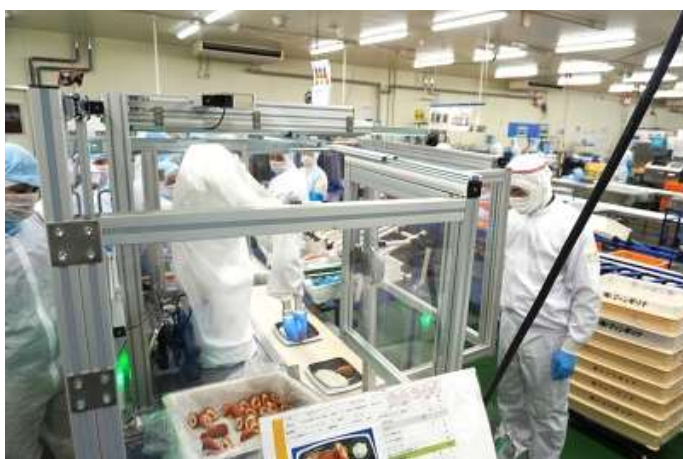
図 2.6.1 フライ投入と弁当盛り付けの 統合システム 出典：日刊工業新聞社
