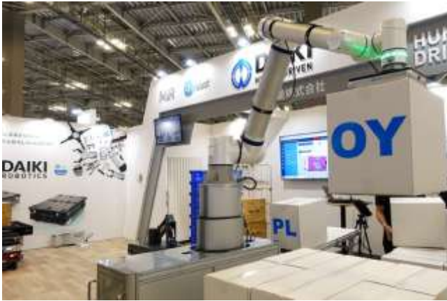
図 2.4.1-2 大喜産業のパレタイジング(荷積み用) ロボット「パルロボット」 出典：日刊工業新聞社
