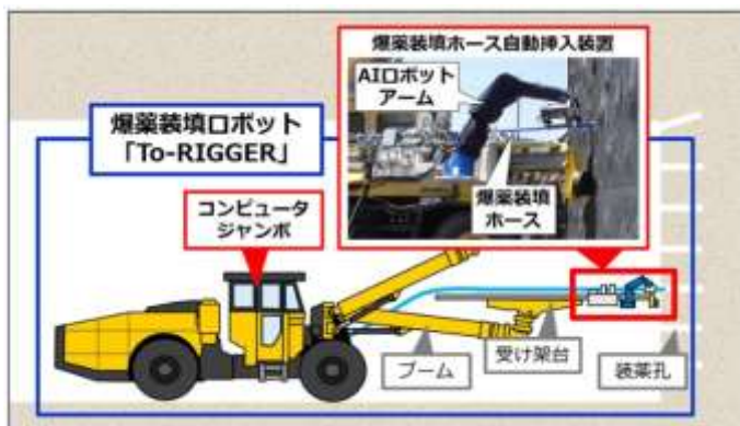
図 2.9.1 「トリガー」による爆薬装填 のイメージ 出典：日刊工業新聞社
