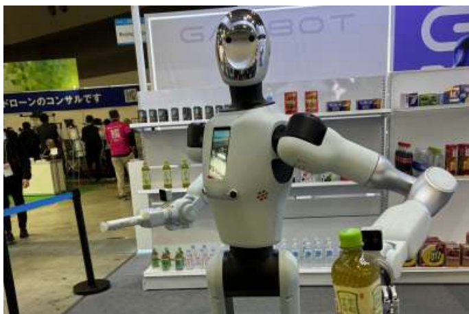
図 3.1.4-1 中国・ガルボットのヒト型ロボット。 スマートフォンで指示した飲料や菓子を棚から取って搬送する 出典：日刊工業新聞社
