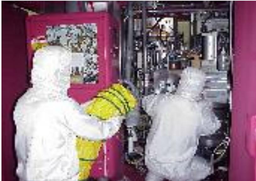
半導体製造装置イオン注入装置のチャンバーメンテナンス作業の例です。この設備は、アルシンガス $AsH_3$ を使用します。ヒ素と水素の化合物です。副生成物の毒性雰囲気を追加排気しながらメンテナンスしています。
