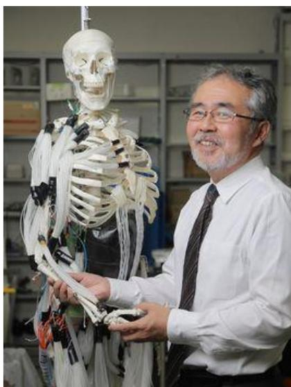
図 2.7.2-3 空気圧でのび縮みさせる人工筋肉で作った「筋骨格ロボット」と鈴森康一・東工大教授。目指すのはやわらか、しなやかロボット
