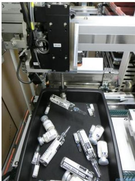
図 2.4.2-1 ロボットアームで返品薬をつかみラベルの情報をスキャンする
