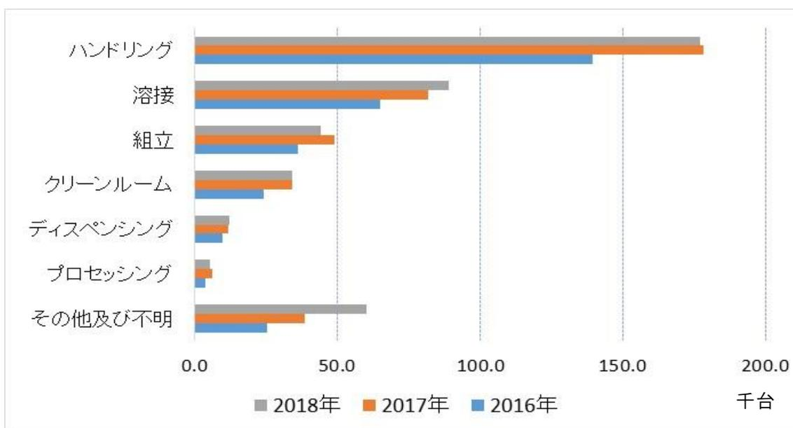
■ 図 2.1.6-1 2016-2018 年での用途別設置状況が総設置台数
