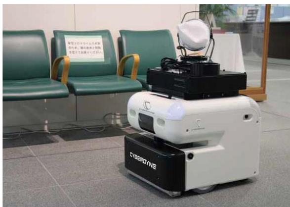
図 4.4.2-1 サイバーダインの除菌ロボット「CL02」 出典：日刊工業新聞社 The Robot
