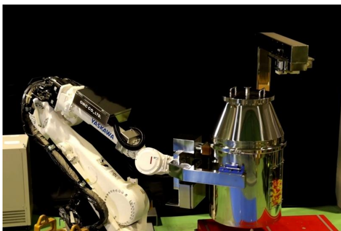
図 3.2-3 ミキシングロボット。粉体や流体が入った容器ごと回転させて攪拌する 出典：日刊工業新聞社
