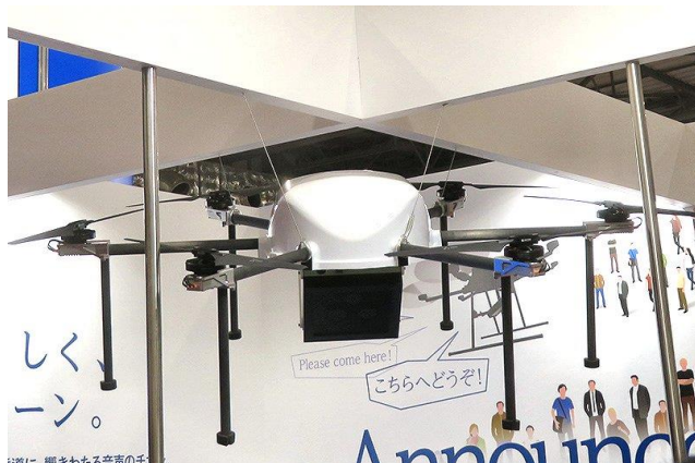
図 2.7.8-1 避難誘導スピーカー双葉電子工業の ドローンに搭載 出典：日刊工業新聞
