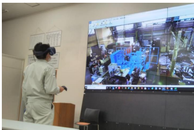
図 3.2-5 ラインの動きをバーチャルシミュレーションで確認できる 出典：日刊工業新聞社
