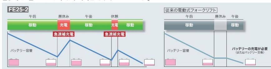
図2 稼働形態とバッテリー容量のイメージ
