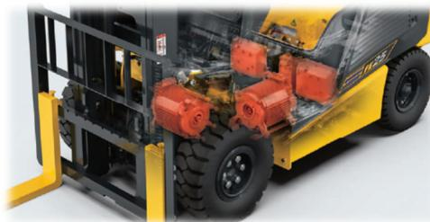
図6 防水性・防塵性を高めた電装品
