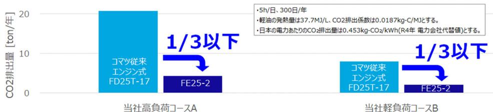
図 7 エンジン式フォークリフトとの CO<sub>2</sub> 排出量比較
