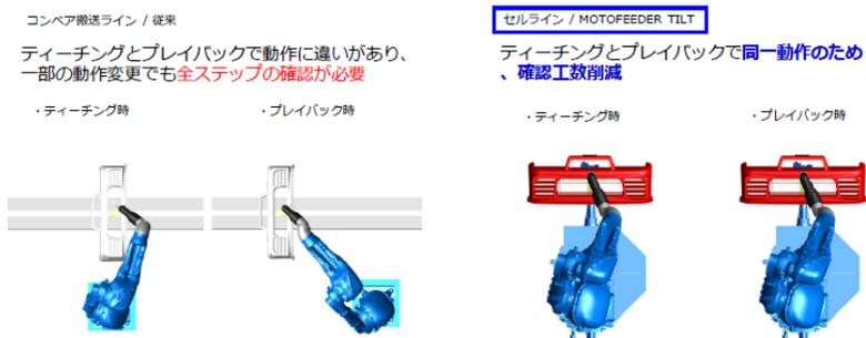
図 9 ティーチングとプレイバックの動作の比較
