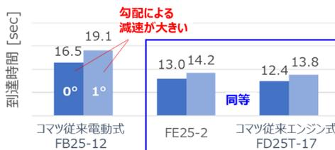
図3 発進加速性能(最大負荷時 勾配0°、1°における50m到達時間)
