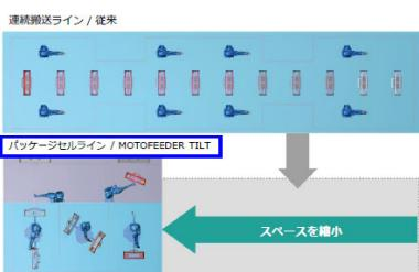
図3 セル塗装への変更例
