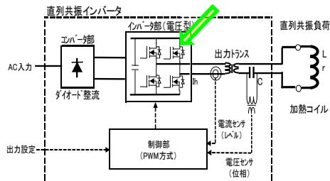
大電力の高速スイッチングが可能になり、インバータの低損失化を実現、並列還流ダイオードのリカバリ特性が良好のため、スイッチング損失も低減。
