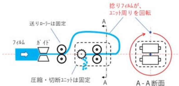
図3 ダブルツイスト方式
