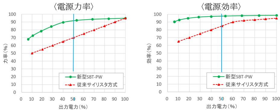
図 6 SBT-PW シリーズと従来サイリスタ方式インバータの比較
