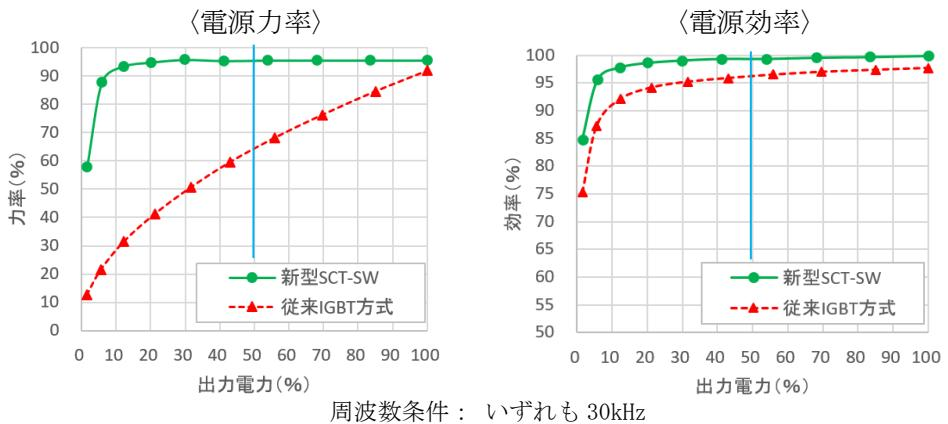
図 7 SCT-SW シリーズと従来 IGBT 方式インバータ(当社製)の比較
