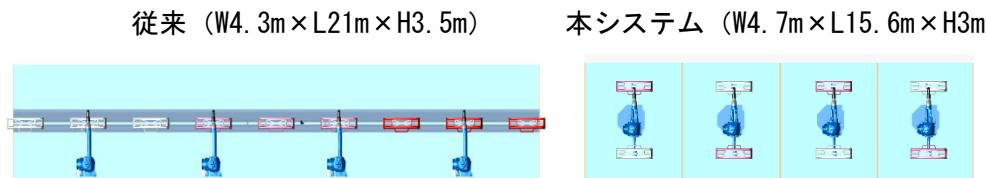
図 10 試算に用いた塗装ブース
