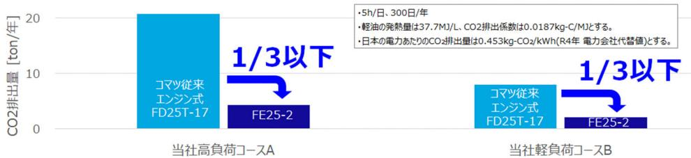
図 7 エンジン式フォークリフトとの CO<sub>2</sub> 排出量比較
