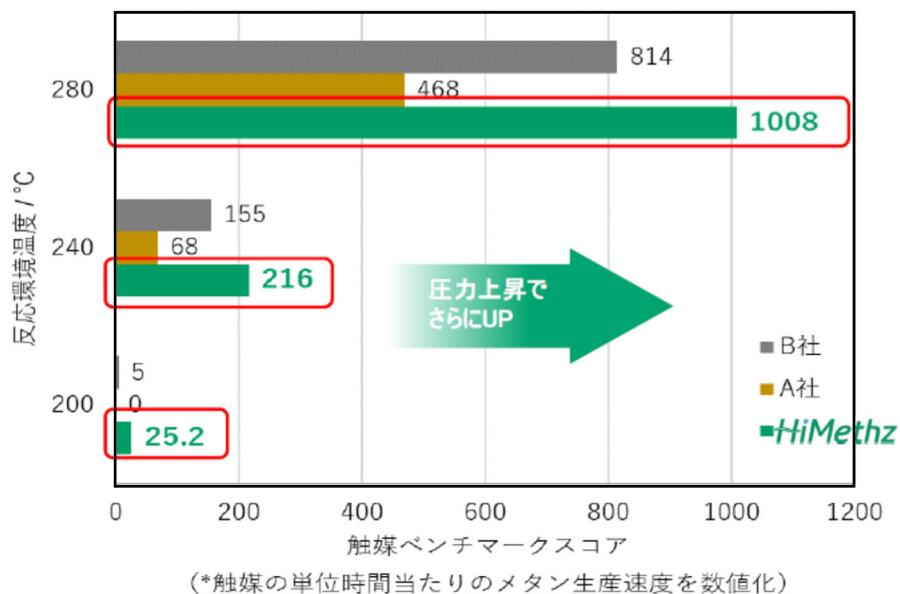
図2 他社触媒とのメタン生産速度の比較
