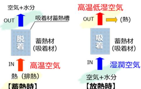
図 2 吸着材蓄熱の概要
