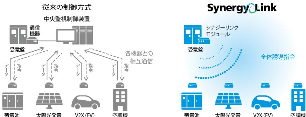
図1 従来の制御方式との比較
