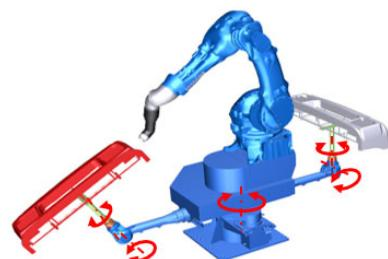
図 2 塗装ロボット搭載例
