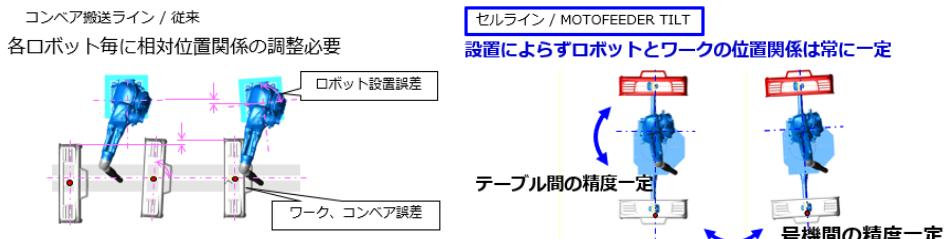
図 8 ロボットとワークの相対誤差の比較
