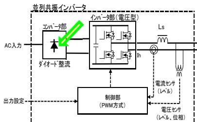
従来のようなサイリスタを使った商用電圧の点弧制御がなくなり、大幅な力率改善と回路電流低減による効率向上を実現。
