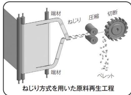
図 1 原料再生工程
