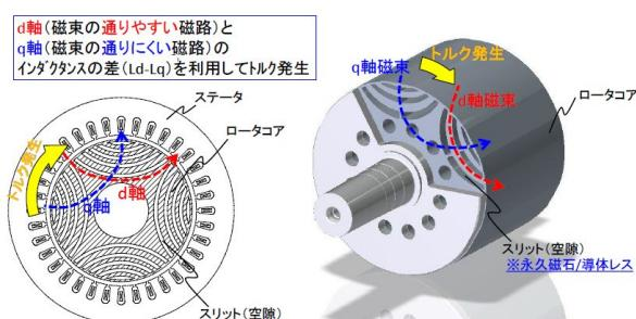
図 3 SynRM の回転原理および回転子イメージ
