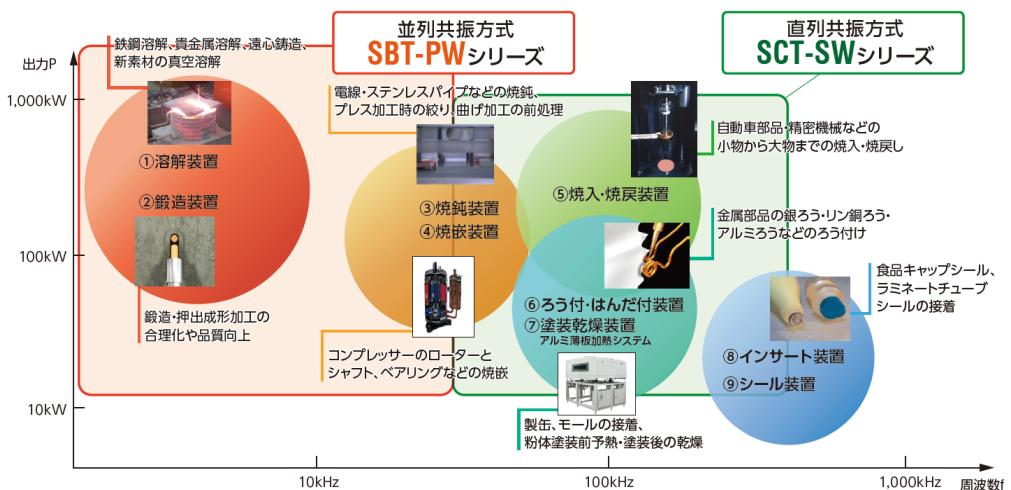
図 8 PWM 制御誘導加熱インバータの用途
