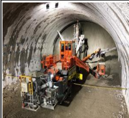
上段： 6m巻きボルト打設装置を搭載した ロックボルト専用ロボット 「BOLTINGER」 大成建設/古河ロックドリル
