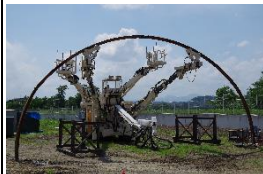
下段： 鋼製支保工建込みロボット 前田建設工業/古河ロックドリル/マック
