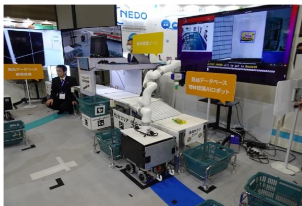
図 2.3.4 - 1 商品登録仕分けロボシステム 出典：日刊工業新聞社
