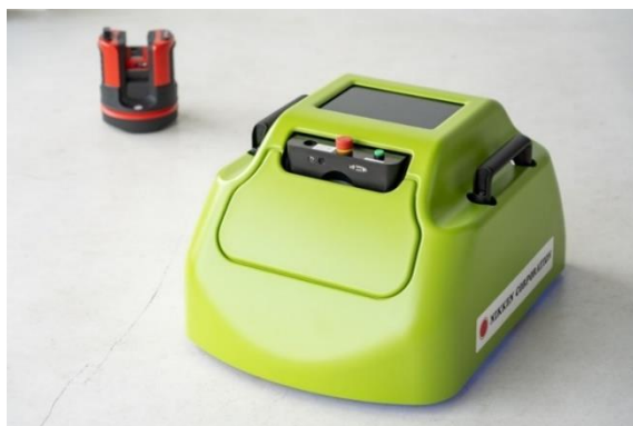
図 2.6.1 - 1 分科会で保有する墨出しロボット 「スミダス」 出典：日刊工業新聞社
