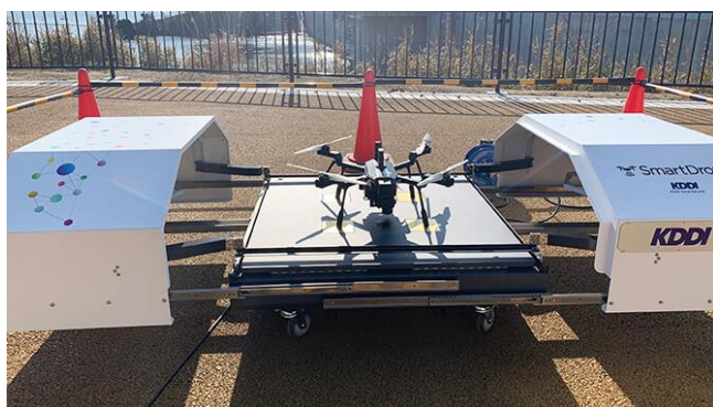
図 2.6.4 - 1 設置した自動充電ポート付きドローン 出典：日刊工業新聞社
