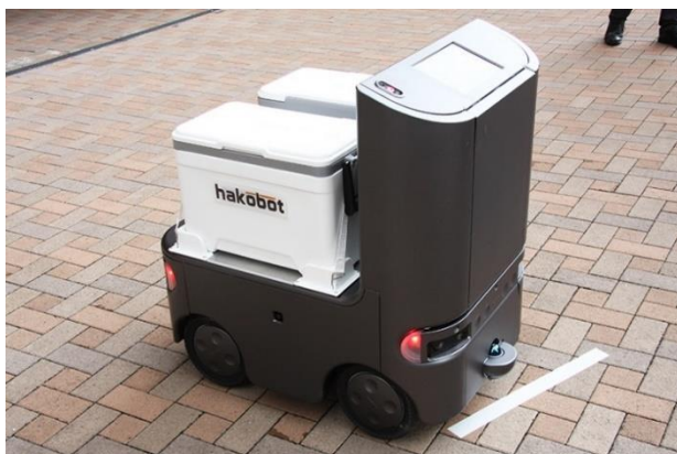
図 3.1.5 - 1 実証実験に使用した 自動配送ロボット 出典：日刊工業新聞社
