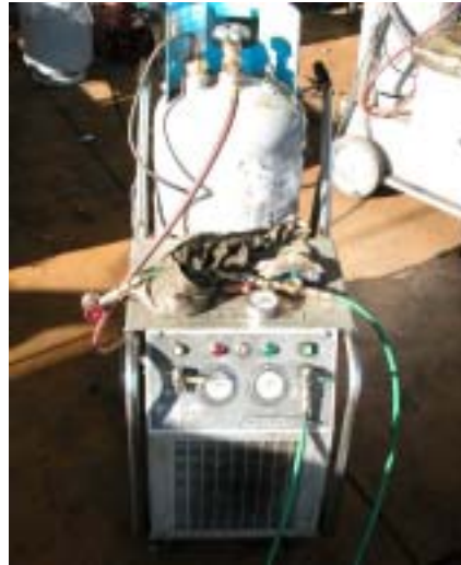
フロン回収装置
