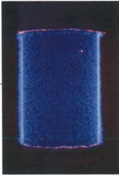
図4. 完全予混合表面 安定燃焼バーナ燃焼状況
