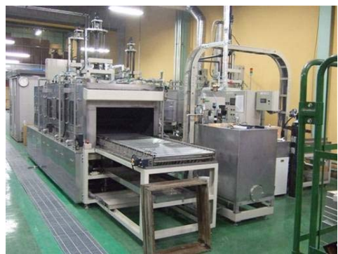
図1 マルチジェット方式を用いたフィルター洗浄装置
