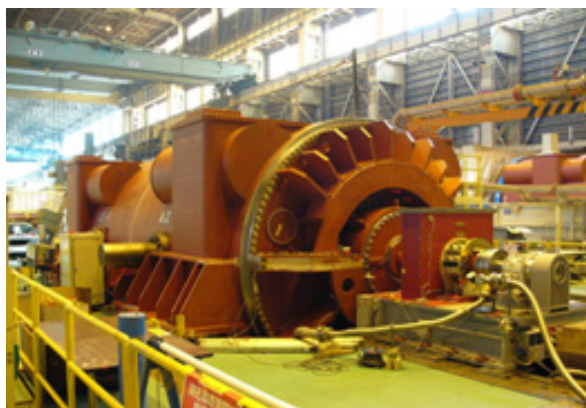
図 1 670MVA 水素間接冷却式タービン発電機
