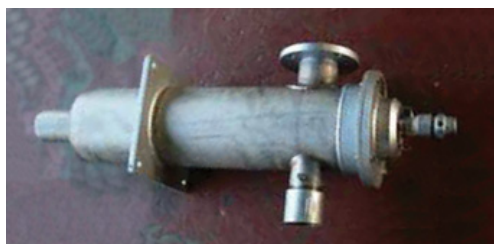
写真1 小型炉用フィン付熱交換器内蔵バーナー 写真2 新バーナー搭載炉
