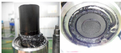
図 7 25,000 回接続・分離後の漏れ
