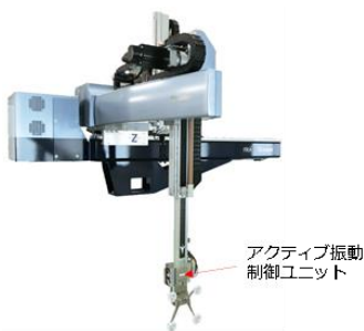
図2 アクティブ振動制御ユニット取り付け部
