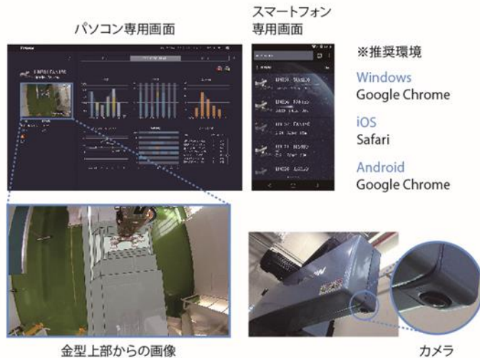
図5 INTU LINE®による生産モニタリング
