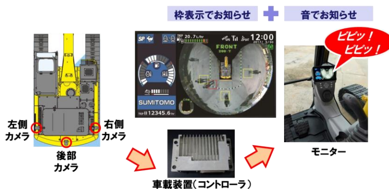
図5 お知らせ機能付周囲監視装置「FVM2」のシステム概要
